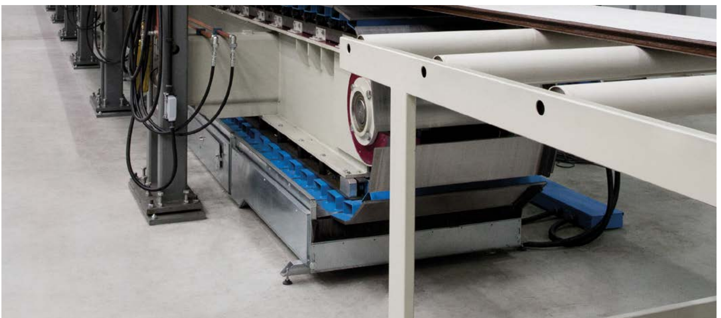
Moderne, computerstyret produktionslinje med en længde på over 200 m, der løbende producerer paneler til ledhøjseporte – tegningen viser stadiet, hvor panelet udformes.
